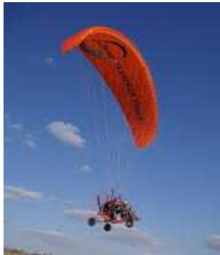
Un paramoteur est un aéronef monomoteur sustenté par une voile souple ou de type parachute. Il répond aux conditions techniques suivantes :
